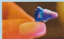
Dieses Hörgerät verschwindet fast im Ohr. Für guten Sitz sorgen flexible Silikon-aufsätze. Blaue Farbmarkierung fürs linke und rote fürs rechte Ohr helfen, es richtig einzusetzen. Hersteller: Silk
